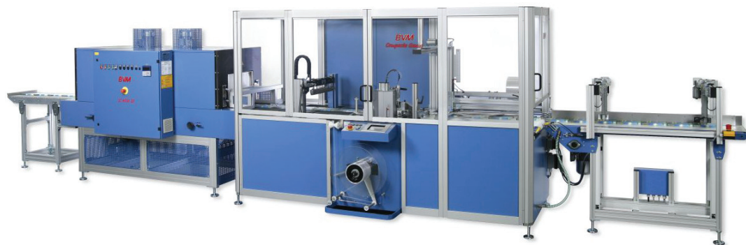
Bild 1. Aus einer Halbschlauchfolie wird eine dreiseitig verschweißte Verpackung hergestellt
