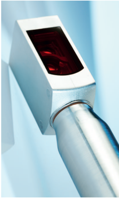
Bild 4. Bei der W4S-3 Inox Hygiene ist die Unterseite der Sensorgehäuse gewölbt, um mittels eines M12-Adaptergewindes oder eines D12-Adapterschafts eine dichte, EHEDG-konforme Verbindung zwischen dem Sensorgehäuse und der Maschine herzustellen
